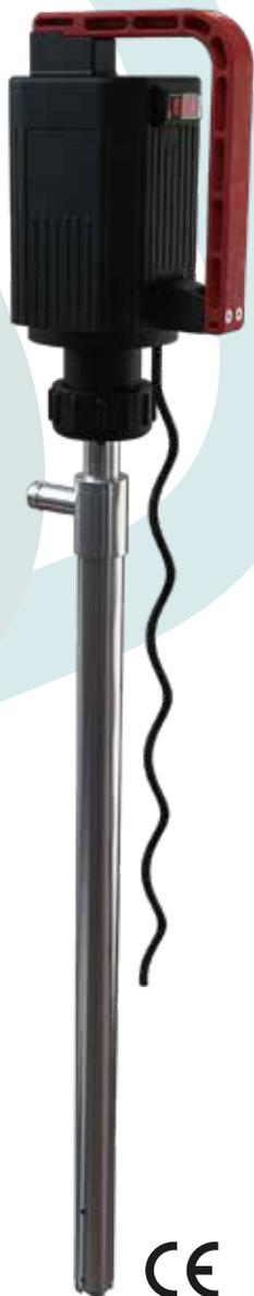
Las bombas trasegadoras para barriles están formadas por un tubo pescante, a cuyo extremo está alojado el impulsor abierto. Está fijada al árbol de arrastre, conectado a la bomba mediante una abrazadera.
