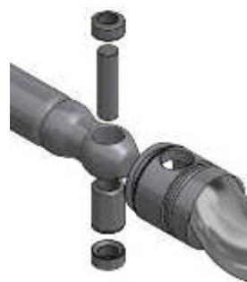
**Maintenance :** La série Diamond DN est conçue pour garantir une maintenance facile en réduisant au minimum le nombre de composants à remplacer. En particulier, les douilles de l'articulation permettent la remise en état de celle-ci sans devoir remplacer les arbres et les rotors. Les coûts de maintenance sont ainsi réduits. Le coût de la machine, si l'on considère l'ensemble de sa vie, s'avère être très compétitif.
